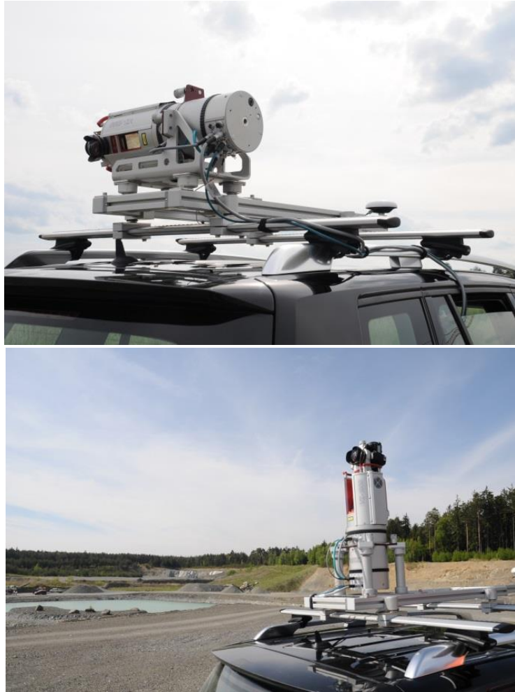
Ryc. 4. RIEGL VMZ – montaż poziomy (po lewej) oraz montaż pionowy (po prawej). Źródło: Jacek Krawiec Laser-3D/ RIEGL.
