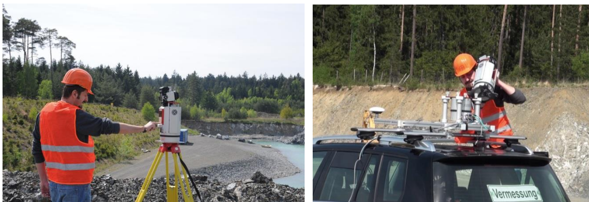
Ryc. 2. Skaner przymocowany do statywu w celu stacjonarnego zbierania danych (po lewej), a następnie dzięki kilku prostym chwytom zamontowany do pojazdu i gotowy do użycia mobilnego (po prawej). Źródło: Jacek Krawiec Laser-3D/ RIEGL.
