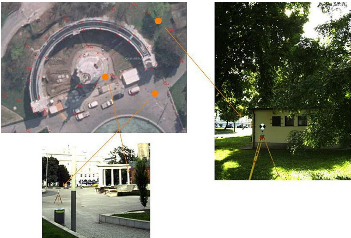
Ryc. 2. Przykład rozmieszczenia stanowisk i osnowy fotogrametrycznej (źródło: opracowanie własne).
