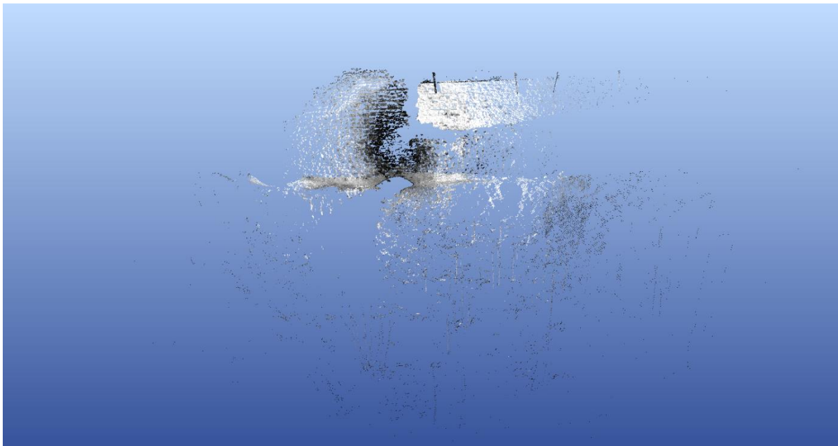
Ryc. 7. Chmura punktów po błędnej filtracji (źródło: opracowanie własne).
