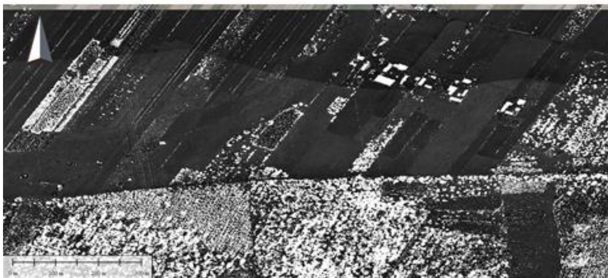
Ryc. 2. Przykładowe pokrycie pomiarem - klasa „grunt” na podstawie danych ALS-ISOK. Źródło: GUGiK / UKSW.
