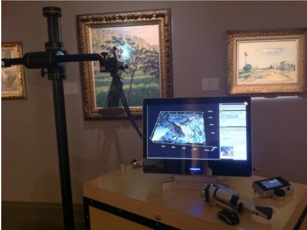
Ryc. 5. Przykładowy pomiar z wykorzystaniem statywu podtrzymującego głowicę mikroskopu. Źródło: Hirox Europe.
