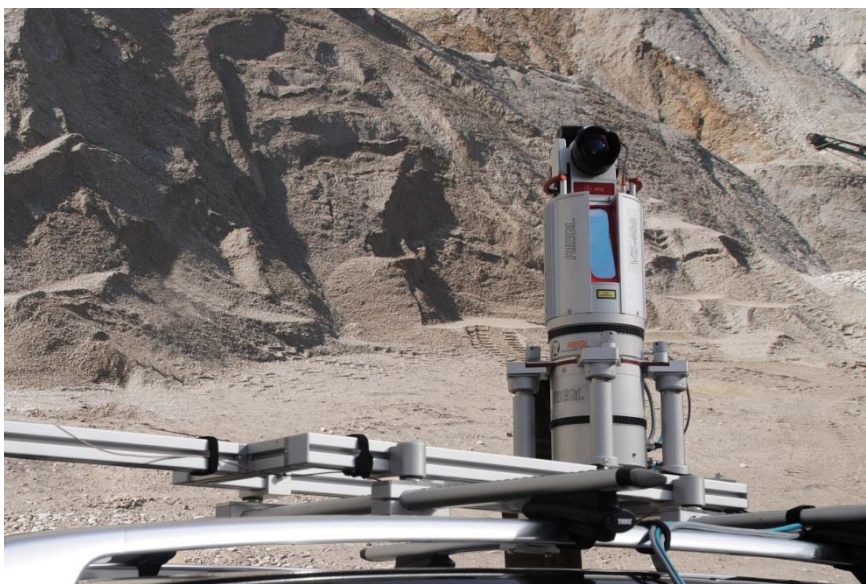
Ryc. 1. RIEGL VMZ Mobile Laser Mapping System: Kombinacja stacjonarnego oraz mobilnego skanera laserowego znajduje szczególne zastosowanie w pomiarach kopalni odkrywkowych, wysypisk oraz kamieniołomów. Źródło: Jacek Krawiec Laser-3D/ RIEGL.
