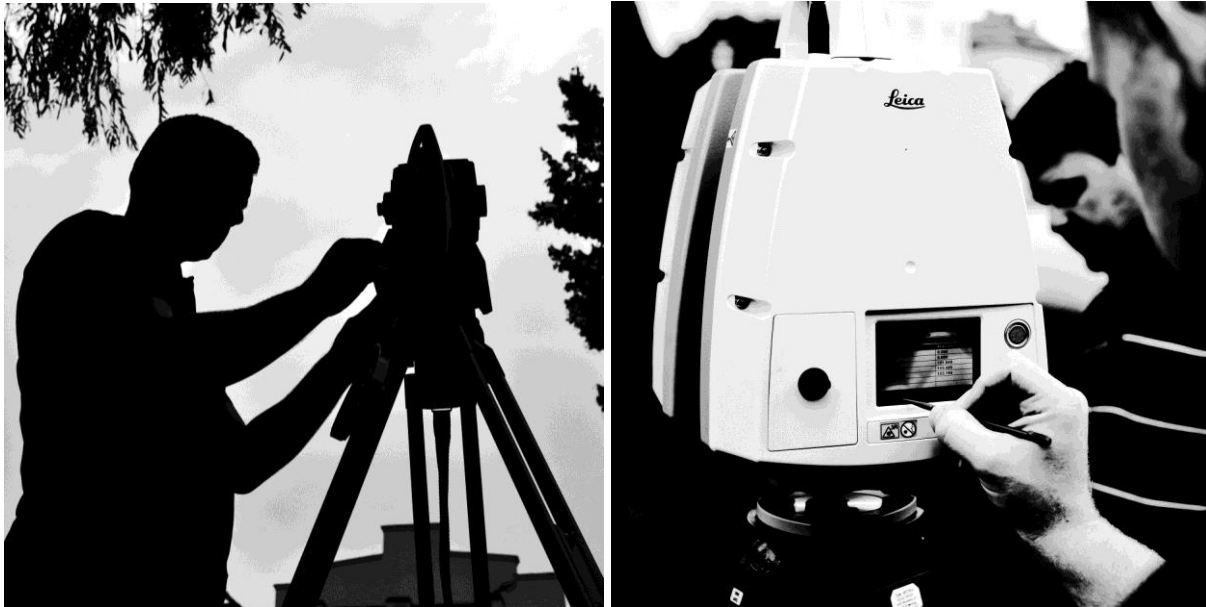
Ryc. 9. Radom – badania fundamentów zabytkowego ratusza w Radomiu. Zdjęcia poglądowe z pomiarów TLS. Fot. R. Zapłata.
