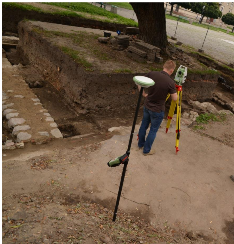
Ryc. 10. Radom - wykop I/2014 - zabytkowe fundamenty ratusza. Pomiary referencyjne tachimetrem i urządzeniami GSP/GNSS. Fot. R. Zapłata
